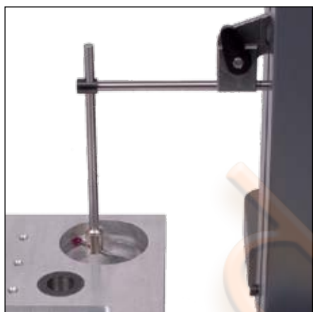
Измерение высоты внутреннего паза (930.2108, 930.2110 и 905.2207)
