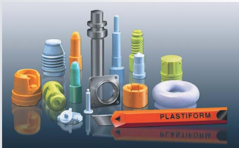
Эластичность PLASTIFORM позволяет получать отпечатки элементов геометрии, в особенности внутренней формы. Полученные негативные копии можно легко измерить оптическими методами. Смешивание обоих компонентов PLASTIFORM ведет к полимеризации, т. е. к получению нового пластика.
