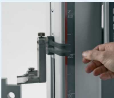
Рис. 2. Включится электропривод и процесс измерения будет осуществлен в автоматическом режиме.
