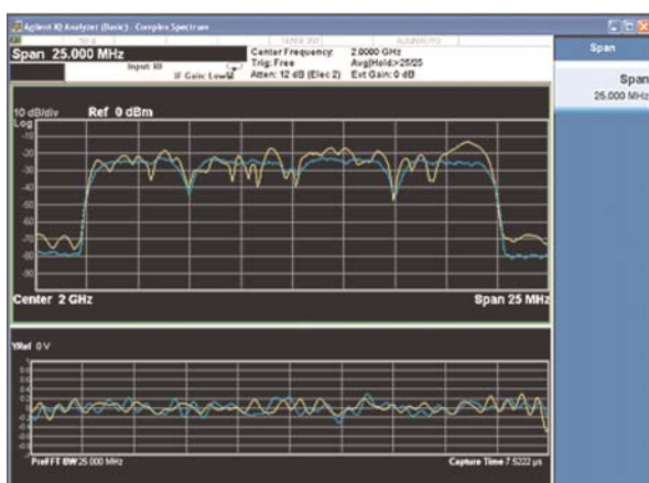
Полоса анализа/демодуляции 25 МГц для сигналов системы WiMAX и других широкополосных сигналов
