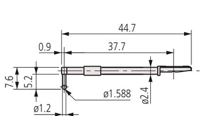
Щуп для измерения шероховатости и волнистости цилиндрических деталей (необходима мера шероховатости 178-611)
