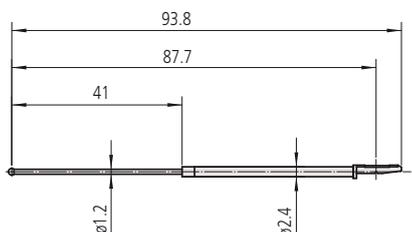
Щуп для контроля шероховатости и волнистости цилиндрических деталей (требуется 178-611)
